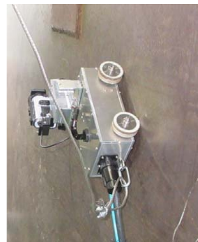
垂直鋼板走行状況
